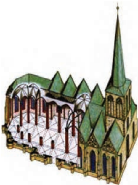
تصویر ۹- طرح کلی یک کلیسای گوتیک
